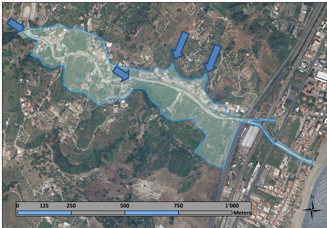
Figura 13 - Dominio di calcolo utilizzato per il modello bidimensionale, con indicazione delle punti di immissione delle portate.
