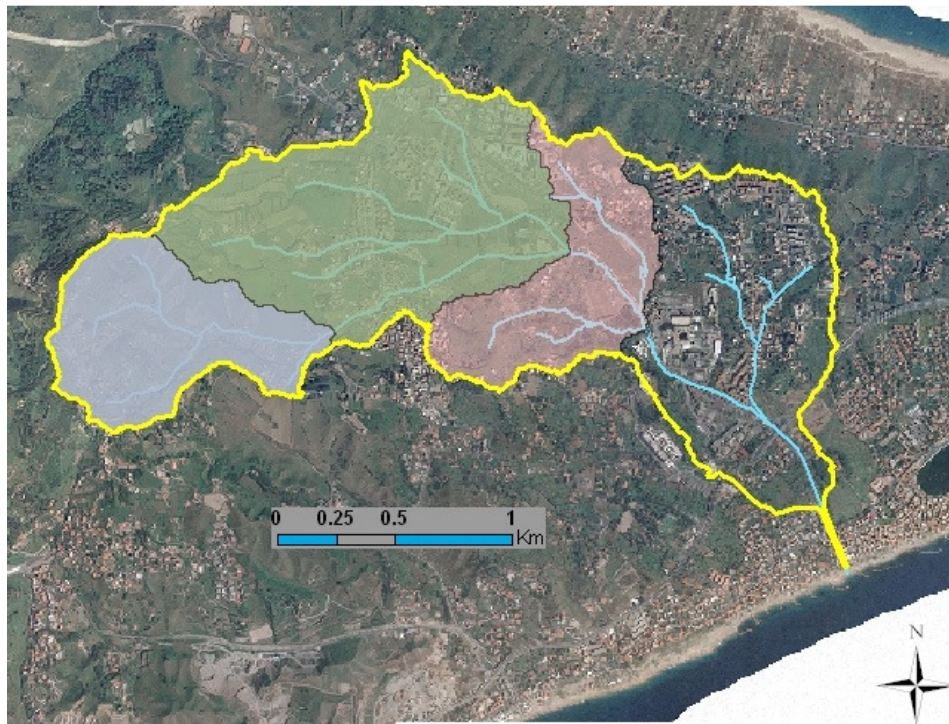
Figura 9 - Sottobacini del Torrente Papardo analizzati nell'ambito dello studio idrologico
